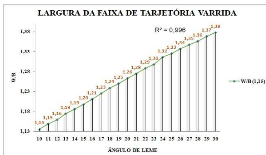
Figura 110 - Largura da faixa de trajetória varrida em função do ângulo de leme e profundidade da água de 1,15
